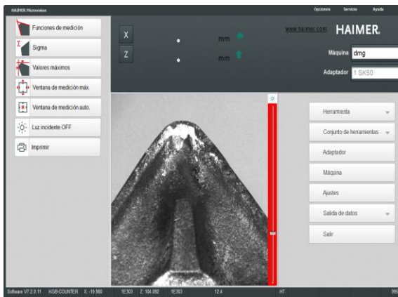
Imagen 9.- inserto trigón Después de uso.
