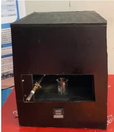
Figura 4. Viscosímetro Saybolt Universal terminado
