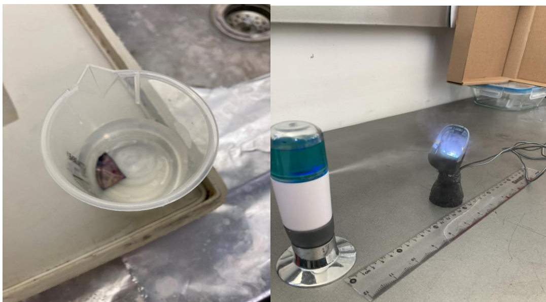
Figura 1 a) obtención de silicio poroso por electro anodización y b) deposito de película delgada de ftalocianina de erbio sobre sustrato de silicio poroso.
