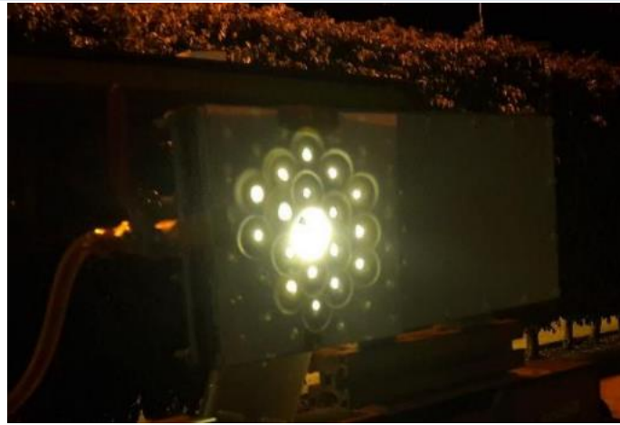
Figura 3. Imagen de los espejos del concentrador en el patrón de alineación.
