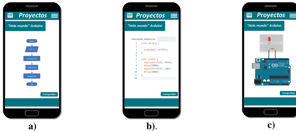
Figura 7. Actividades del apartado de “Proyecto”. a) Diagrama de flujo, b) Código del proyecto, c) Conexión del circuito
