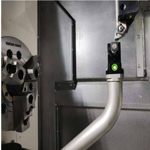
Imagen 7.- medición optoelectrica de herramienta
