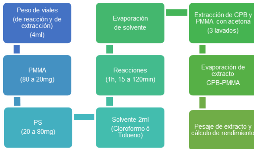
Figura 4. Ruta seguida para síntesis de CPBs PS-block-PMMA
