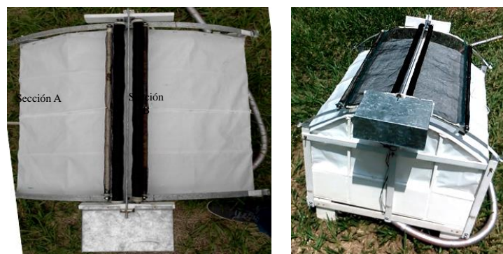
Figura 1. Cámara de ambiente controlado exterior.
