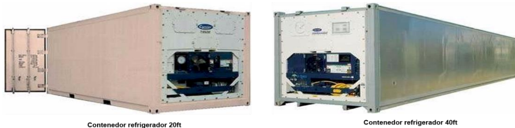
Figura 2.- Contenedor refrigerador de 20 ft y 40 ft.
