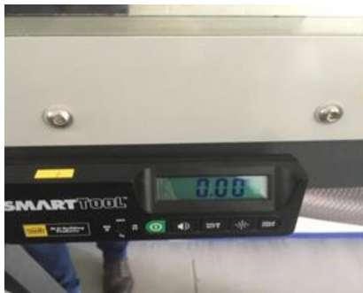
Figura 2. Fijar el canal con S < 0.0025
